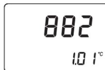
2. Continuando a tener premuto il tasto ON/OFF, premere il tasto RANGE. Il display mostrerà il fattore di conversione corrente sul display primario e "P.ALc". Continuare a tenere premuto il tasto ON/OFF. Premere il tasto ZERO per incrementare questo valore. Il valore aumenterà sino a che si raggiunge "0.70". C1 indica "Curva 1", (per questo vedere a pag.9). Quando si raggiunge il fattore di conversione desiderato, rilasciare il tasto ON/OFF. Il nuovo fattore di conversione verrà utilizzato.
